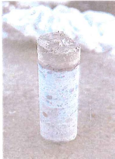
Bild 27: Bohrkern aus Achse 10,30 m von Versuchskörper 2
