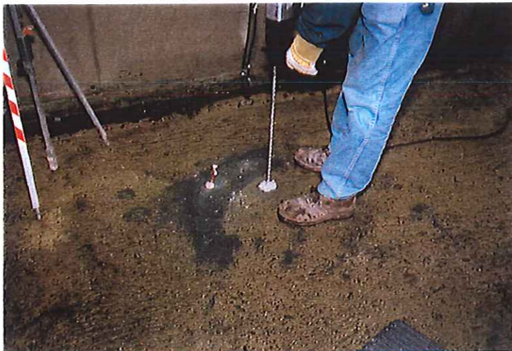
Bild 9: Durchbohren der Bodenplatte von Versuchskörper 1
