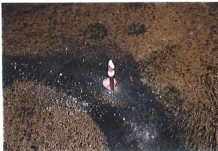
Bild 9: Durchbohren der Bodenplatte von Versuchskörper 1
