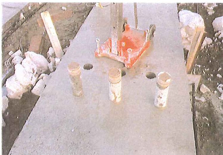
Bild 26: Bohrkernentnahme in Achse 10,30 m des Versuchskörpers 2
