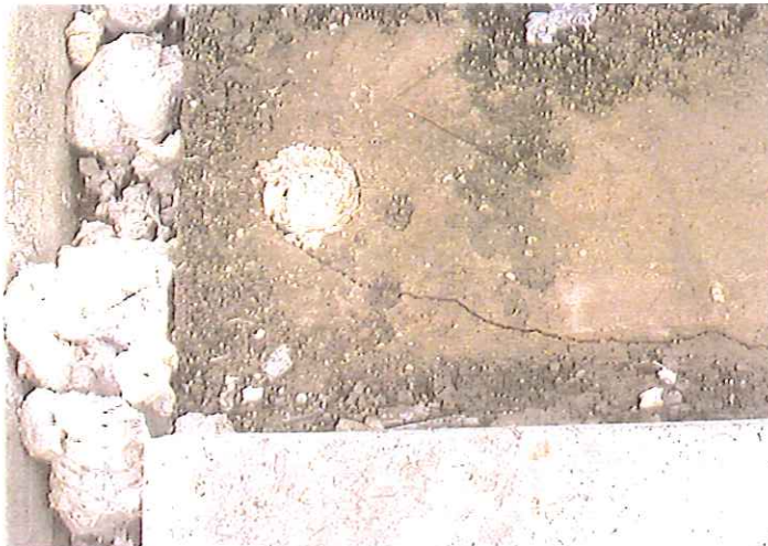
Bild 23: Rißbildung in der HGT von Versuchskörper 3
